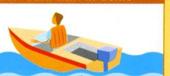
Avant de partir, contrôler les équipements du bateau : gilets, écope, ancre, rames ou pagaies, coupe-circuit, lampe torche, etc... Vérifier les feux de navigation de nuit, etc... Moteur à essence : ventiler la cale avant chaque démarrage.
